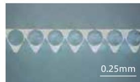
高精度ダイシング加工機を使用した微細加工
