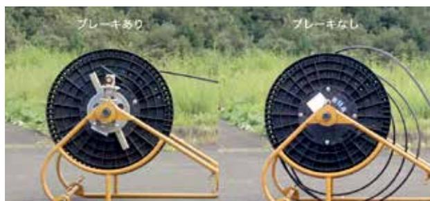
電線ドラム回転抑制機で、ケーブルのたるみ・絡まりを解消
